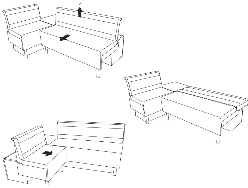
**6** А. Установить сидения 1x, 2x на соответствующие ящики , и сидение - стол на угловой элемент (имеет два положения сидение и стол)
